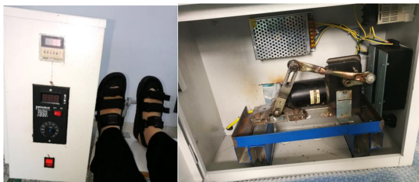
图 44 自动化踝泵康复器外观及内部结构图
